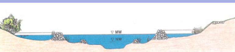
Im Querschnitt von 1880 sind die Eingriffe in den Wasserlauf durch die »Mittelwasserkorrektion« deutlich sichtbar. Buhnen am Rand sorgen für die Freihaltung der vom Menschen geschaffenen Fahrrinne.
