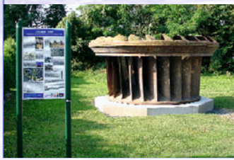
Am Start steht ein Turbinenrad aus dem Wasserkraftwerk der einstigen Staustufe Mainaschaff.
