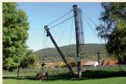
„Derrick-Kran“ zur Verladung der Steine am Mainufer.
